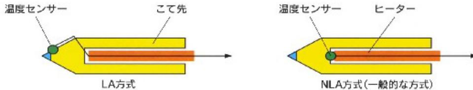
現在、広く普及しているNLA方式の溫度センサー取り付け場所は、ヒーターとこて先の間位置する為、ヒーターの急激な溫度変化の影響を受ける事と、こて先・先端までが遠いのでタイムラグが生じる事により、実溫度変化の正確さに欠けると言わざるを得ません。小さくて高い発熱機能を必要とするはんだこてでは、わずか数ミリの違いで大きな誤差が生まれます。これに対して「LA方式」は、センサーがこて先・先端の表面に位置している為、はんだ付け時の実際の溫度変化を”正確に”リアルタイムで把握でき、コントローラーの溫度表示と溫度範囲異常を知らせる警報音の併用で動的な溫度管理を行うことができます。
