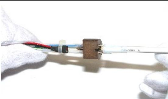
⑨ ヒーターを外し、新しいヒーターを取り付けます。ヒーター交換は終了です。
