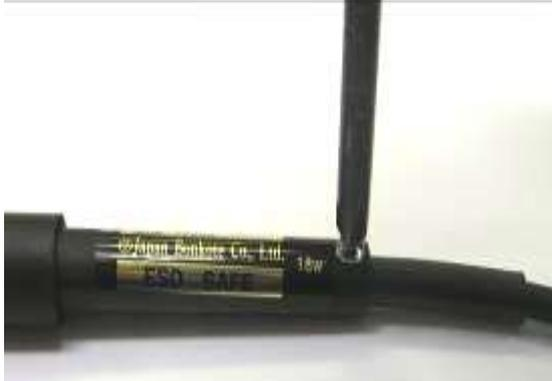
⑯ グリップ端部のセットボルトをプラスドライバーでしめます。
